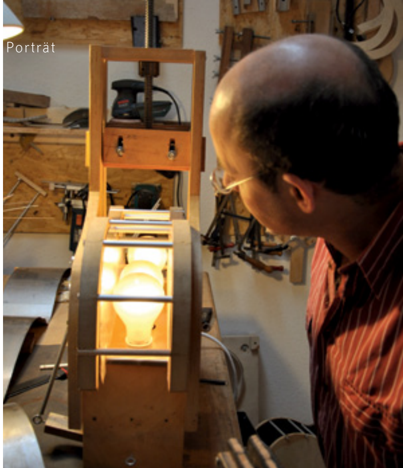
Der „Fobender“, benannt nach dem Gitarrenbauer Charles Fox, erleichtert das Biegen der Zargen über der heißen Spezial-Birnen.
