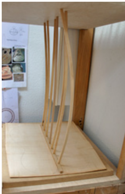
Mit Hilfe biegsamer Latten wird die Mittelleiste auf den Boden gepresst.
