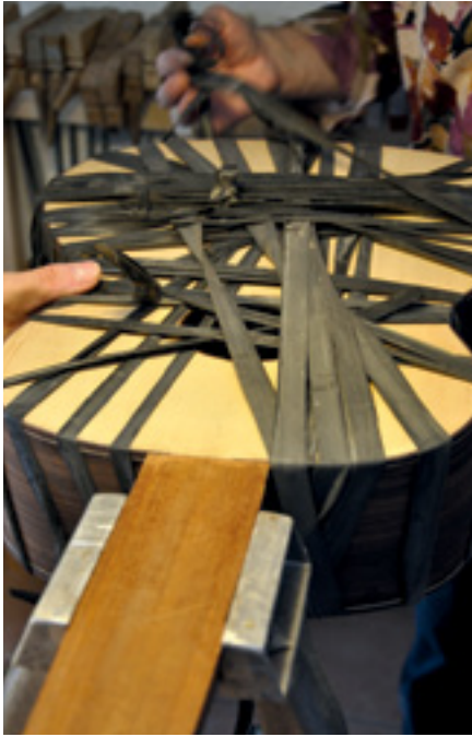
Bänder statt Zwingen: Ein Korpus wird in seiner Endform verleimt.
